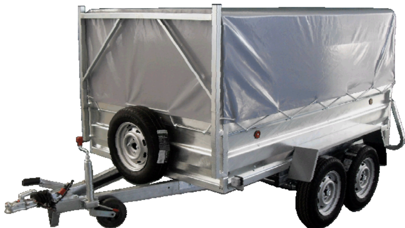
DEFS-256x150 Soldado caja arquillos y toldo con caballete de albañil
