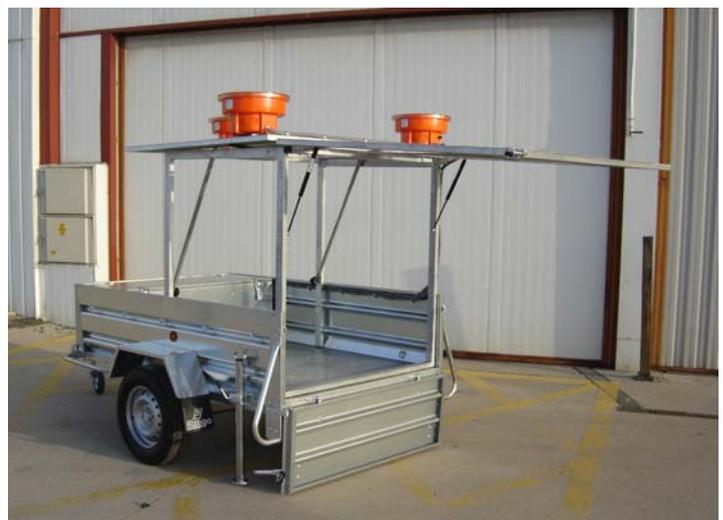
⇒ Se puede montar sobre remolques de 1200mm interior de caja
