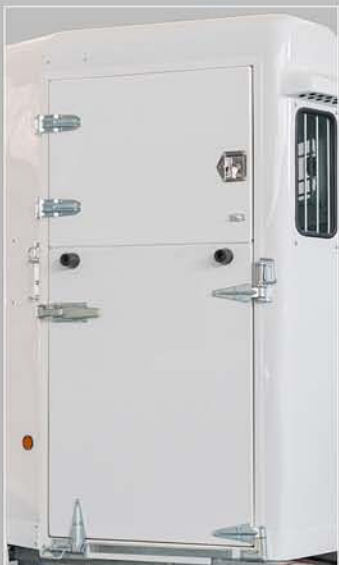
Puerta delantera con doble apertura lateral y en rampa Porte avant à double ouverture pont ou portee avec volet Front door with double opening, pedestrian or ramp
